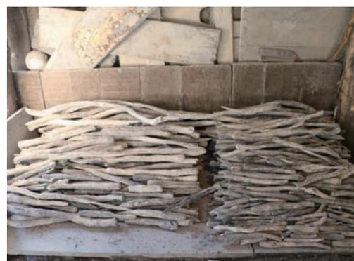
▲切断の際にはダイヤモンドカッターを使用するほど鋼鉄並みに高い硬度を誇る
