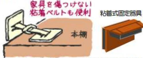
タンスと同じように、壁の中の硬い所があるとボール式器具を取りつきます。また、壁に穴をあけないタイプの粘着式の固定器具もあります。
