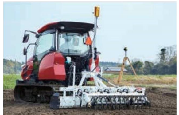
↑ レベラーでほ場を均平化しておく と浅水代かきがしやすくなります
